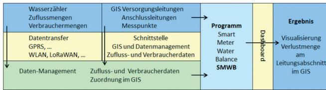
Abb. 3: Datenfluss zur Leckmengenerfassung im Verteilnetz am Leitungsabschnitt
